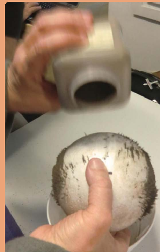
Figura 15 e 16: La limatura di ferro sulla terra magnetizzata indicherà la direzione dei poli e poiché si raccoglierà molta più limatura in questa zona rispetto all'equatore si potrà verificare che il campo magnetico è più forte nei poli che all'equatore.
