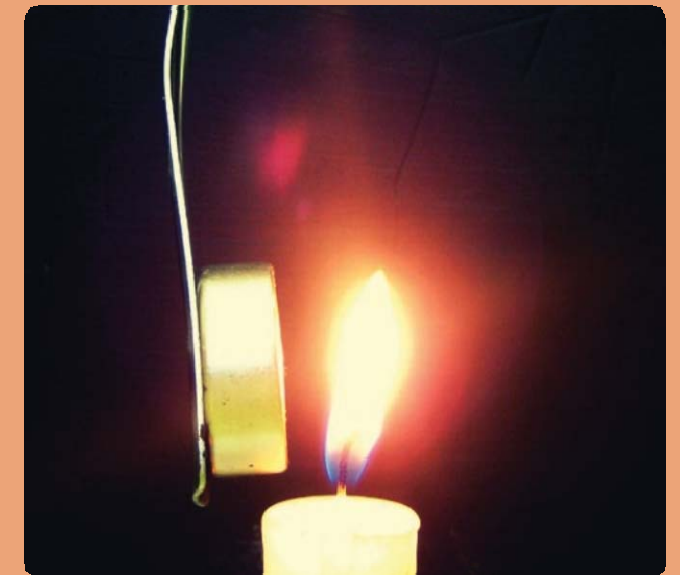
Figura 24: La fiamma della candela verticale senza magnete Figura 25: La candela deviata quando il magnete si avvicina.
