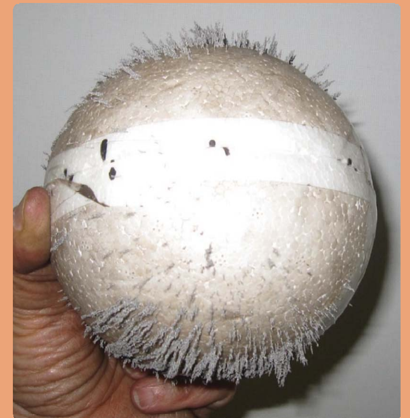
Figura 15 e 16: La limatura di ferro sulla terra magnetizzata indicherà la direzione dei poli e poiché si raccoglierà molta più limatura in questa zona rispetto all'equatore si potrà verificare che il campo magnetico è più forte nei poli che all'equatore.
